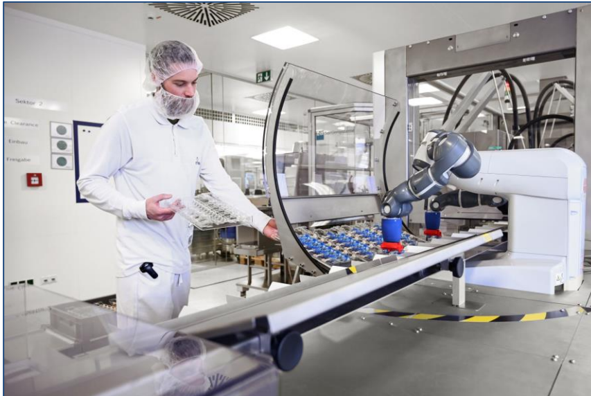
Zusammenarbeit von Mensch und Maschine in der Endverpackung. Bildquelle: Vetter Pharma International GmbH
